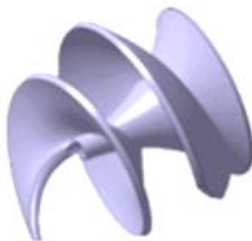
Рис. 2. Робочий орган насоса – шнек
