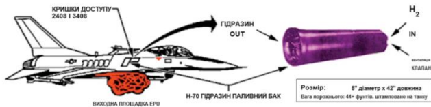
Рис. 1. Паливний бак з гідрaziном
