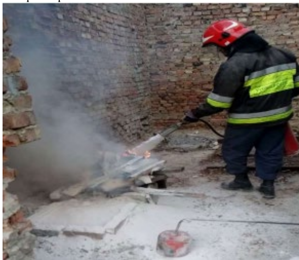
Рисунок 1. Гасіння комбінованої пожежі деревини і магнію після подавання порошку
